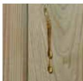
Holz verändert sich durch Lagerung und Verarbeitung im Volumen und in der Dichte. Ein Phänomen bei Nadelhölzern während dieses Vorgangs ist das Austreten von Harz an die Oberfläche. Dies ist vollkom-
