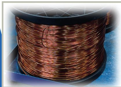
Nous fabriquons des **enroulements de classe H** avec des conducteurs à double émailage pour garantir une longue durée de vie.
