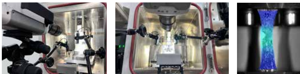
Test setup with STEP Lab drop weight tower and Photron high speed camera. / Configurazione di prova con torre di caduta STEP Lab e telecamera ad alta velocità Photron.
