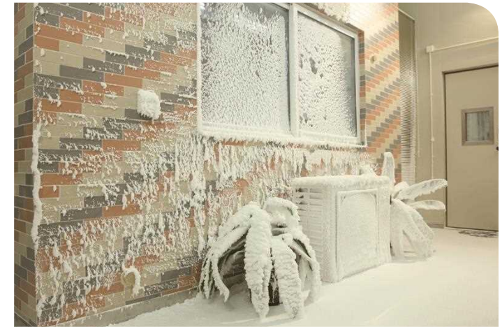
空调住宅环境试验室 Environment Test Chamber for Air Conditioner ルームエアコン住宅環境試験室
