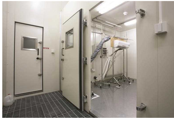
空调热平衡试验室 Balanced Ambient Room-Type Calorimeter バランスタイプカロリメーター
