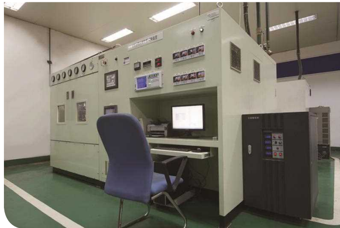
空调压缩机性能试验台 Air Conditioner Compressor Calorimeter エアコンコンプレッサー性能試験装置
