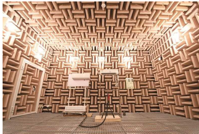
空调消声室 Anechoic Chamber ルームエアコン騒音室
