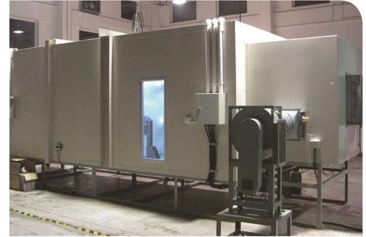
风机性能试验台 Fan Performance Test Bench ファン性能試験装置
