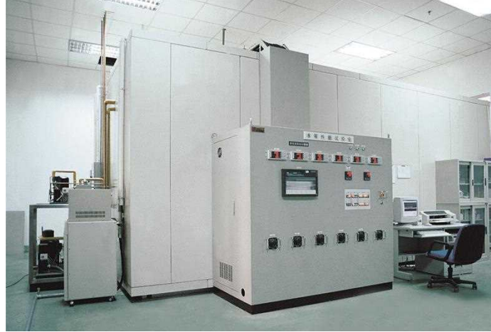
冰箱/冷柜性能试验室 Refrigerator and Freezer Calorimeter 冷蔵庫とショーケース性能試験室
