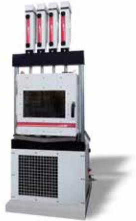
Macchina per prove creep fino a 5 assi
