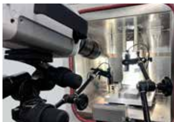
Test setup with STEP Lab drop weight tower and Photron high speed camera. / Configurazione di prova con torre di caduta STEP Lab e telecamera ad alta velocità Photron.
