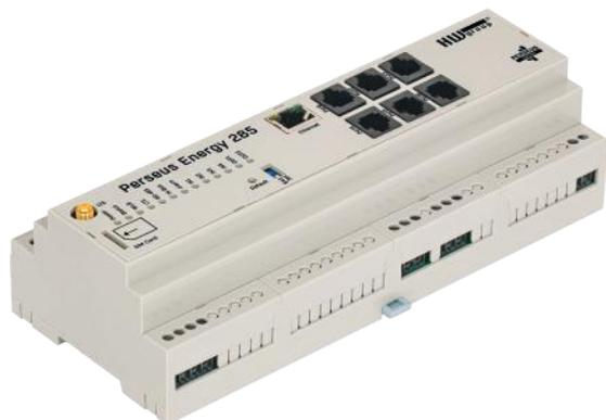
*Solution LAN et LTE sur rail DIN pour les applications de surveillance et de contrôle à distance de l'énergie avec un maître M-Bus.*
