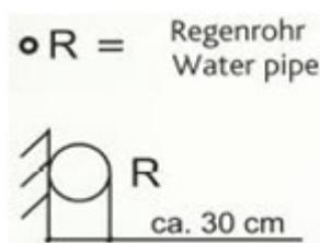
Die Wasserleitungen sind immer an der Säule befestigt. Das Wasserleitungssymbol auf dem Grundriss zeigt nur an, auf welcher Seite des Pfeilers sich die Leitung befindet. Der maximale Abstand vom Hallenpfeiler zur Wasserleitung einschließlich der Befestigungen. Die Befestigungen der Rohre können von Pfeiler zu Pfeiler unterschiedlich sein.
