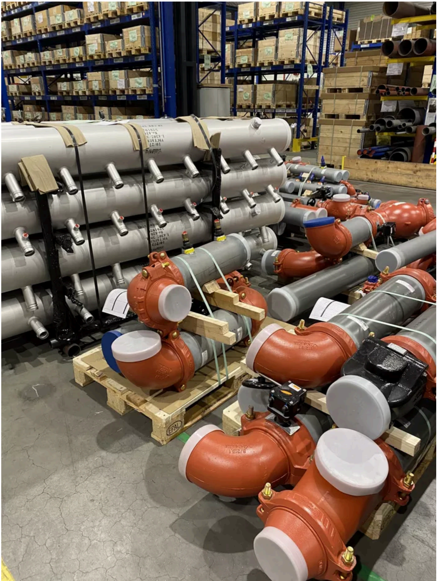
Sections de tuyauterie préfabriquées équipées de raccords Victaulic, prêtes à être livrées. Victaulic
