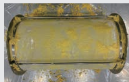
原料が付着したシーブ Sieve with materials attached
