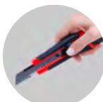
**Prédécoupez le film avec le cutter à un format supérieur de 2 à 3 cm à celui du vitrage**
