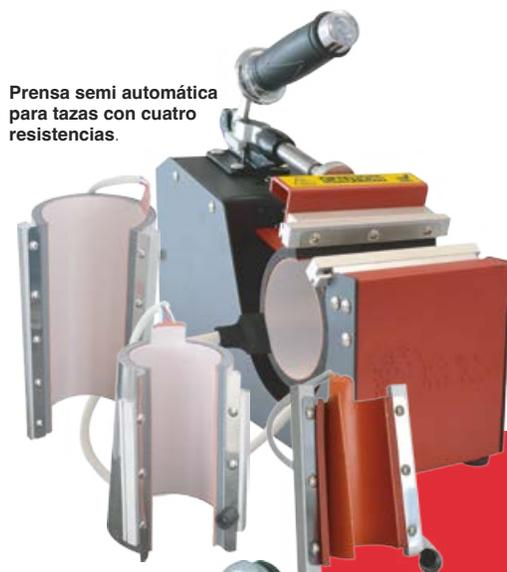
Prensa semi automática para tazas con cuatro resistencias.
