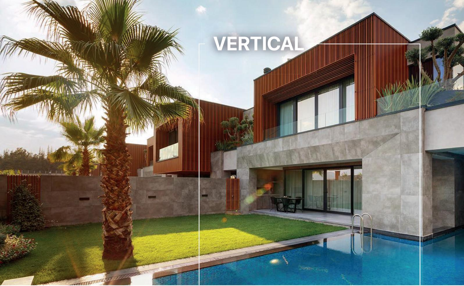
Diğer cephe kaplama yapı elemanlarına göre daha hafif yapıya sahip olması, köşe dönüşlü alanlarda özel çözüm detayları sunması ile yapıyı tamamen saran bir kabuk olarak yer alabilmesi, sistemin diğer alternatif cephe kaplama çözümlerinin ötesinde tercih edilen bir sistem olmasını sağlamaktadır.
