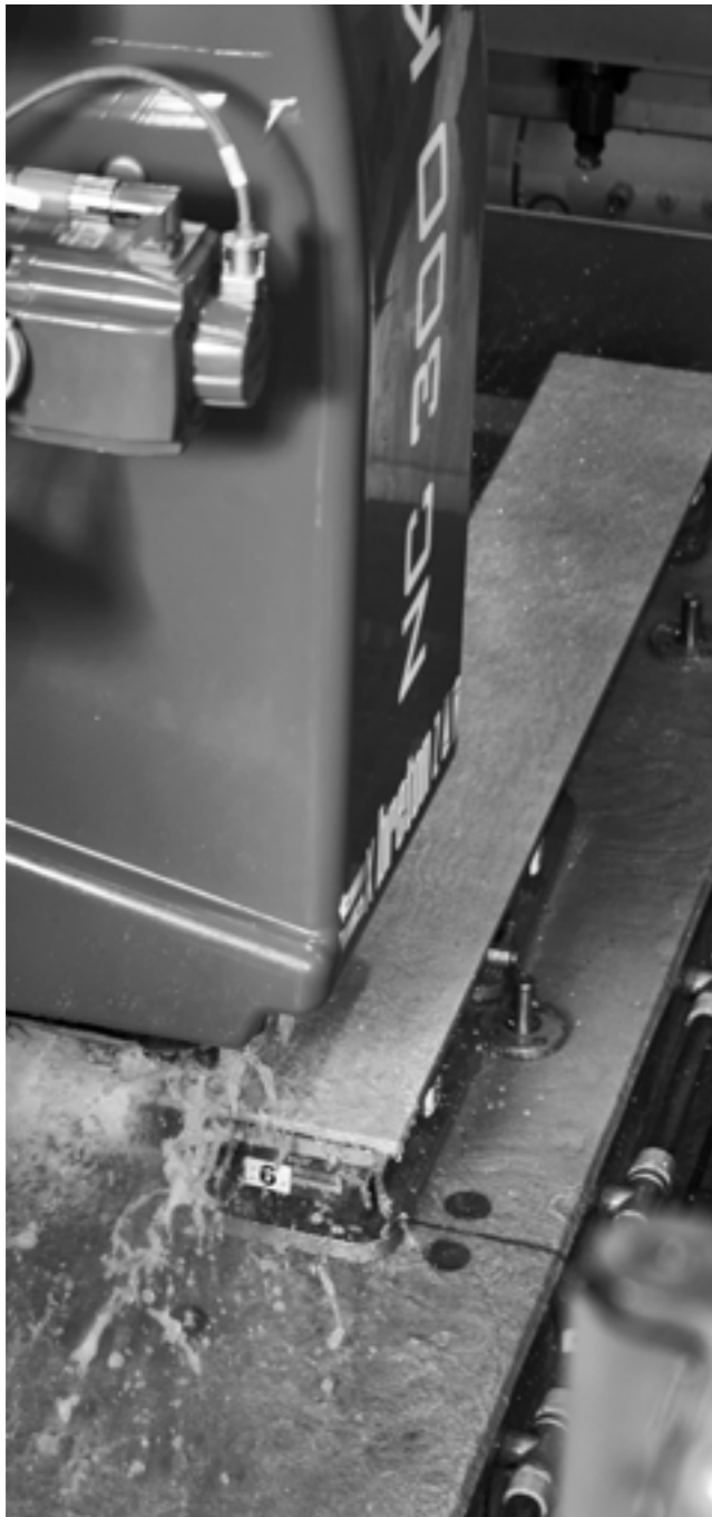
CNC EDGE PROFILING (FIG.41.1)
