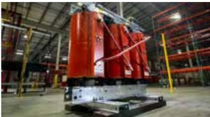
Da die Gehäuse den für die Kühlung erforderlichen natürlichen Luftstrom einschränken können, hat TMC innovative Kühloptionen wie AFAP (Air Forced Air Forced)- und AFWF (Air Forced Water Forced)-Wärmetauscher entwickelt, um die Temperatur zu kontrollieren und die Effizienz zu verbessern. Damit sind seine Produkte perfekt für den Einsatz im Freien geeignet.
