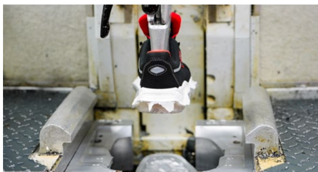
Produktionsabfall als Feststoffzudosierung der Zwischensohle
