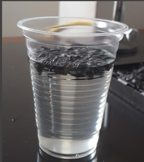
Figura 4: Rangos de densidad de plásticos RAEE
